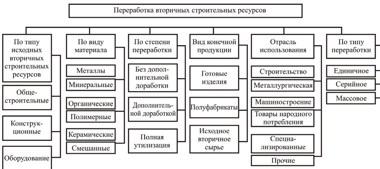
**Рис. 3.** Организационно-технологическая схема комплексной переработки вторичных строительных ресурсов
