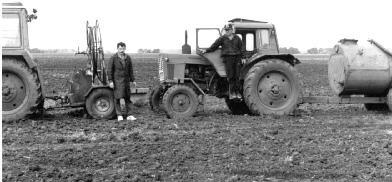
**Рис. 1.** Транспортное положение комплекса машин по промывке дрен
