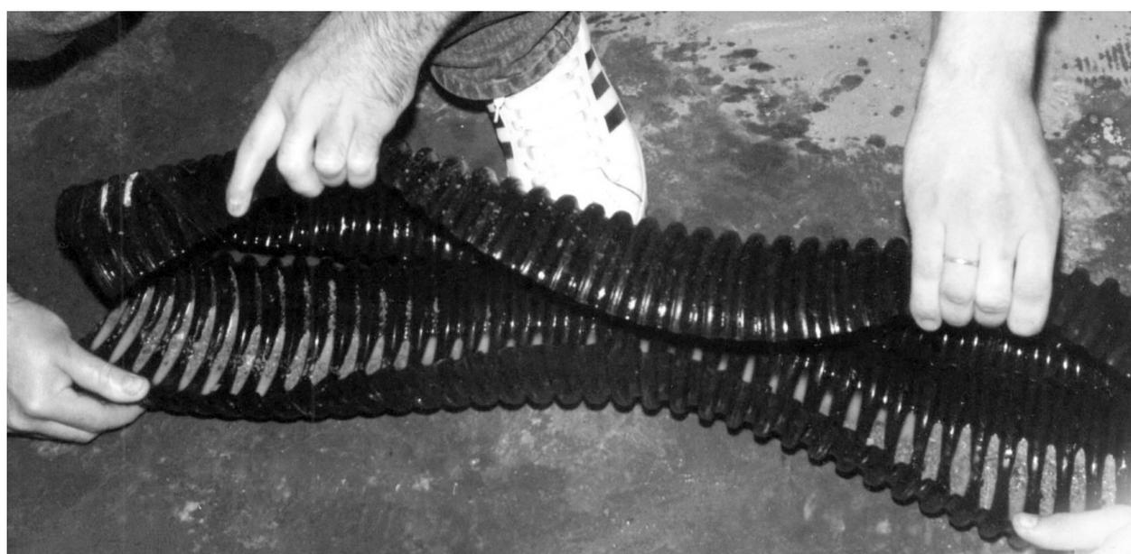
**Рис. 4.** Определение степени очистки дренажной трубы
