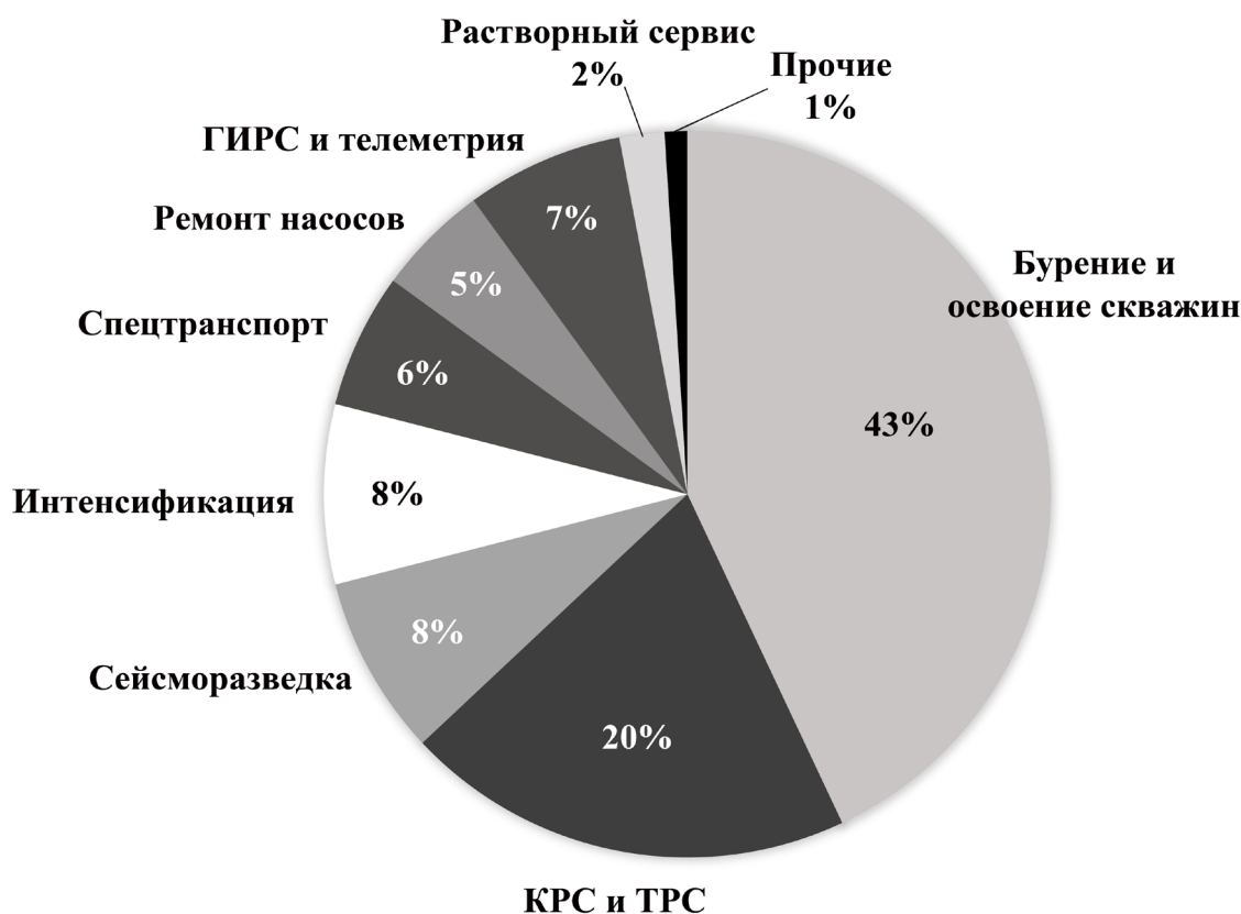
Рис. 1. Структура российского нефтесервисного рынка по видам услуг, % (составлено автором по открытым данным)
