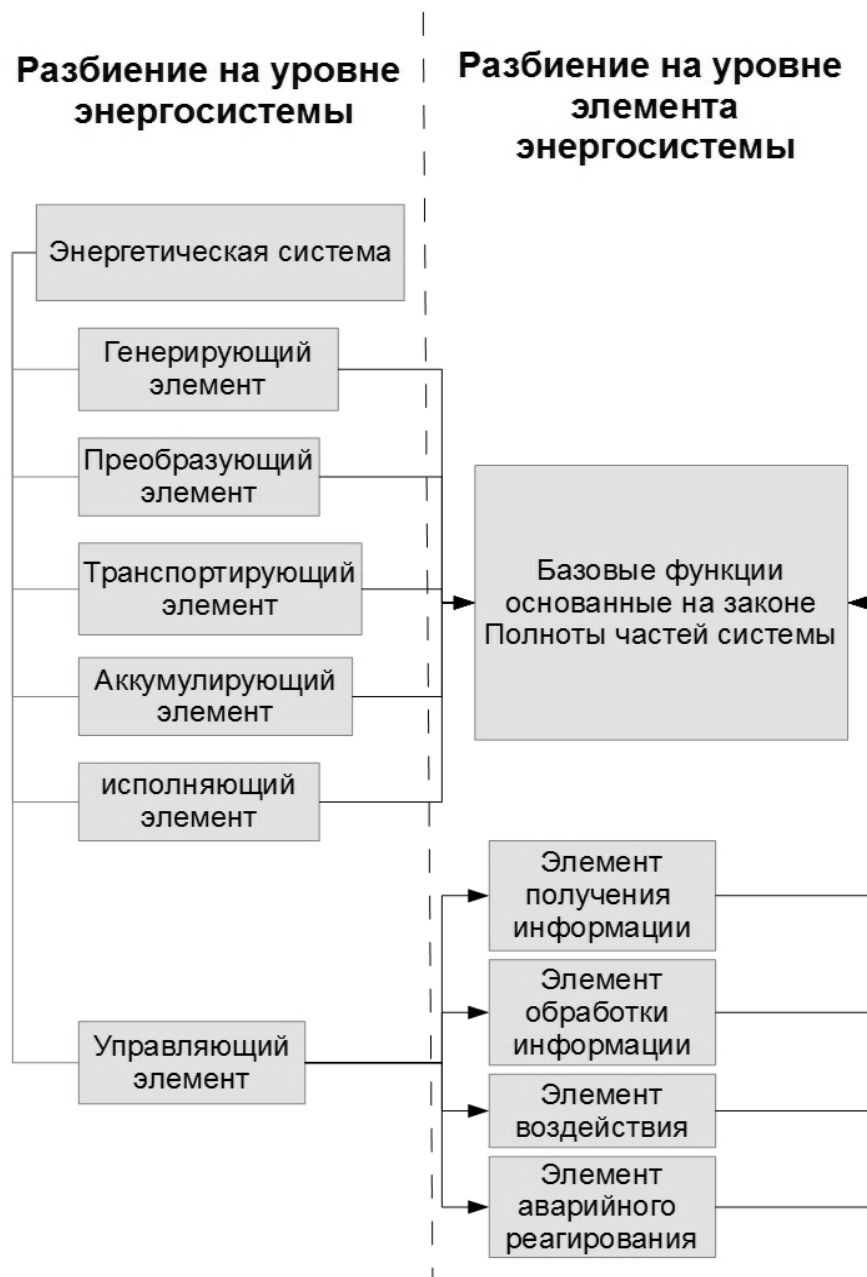
Рис. 1. Карта типовых базовых элементов для энергосистемы с приведением различных уровней разбиения
