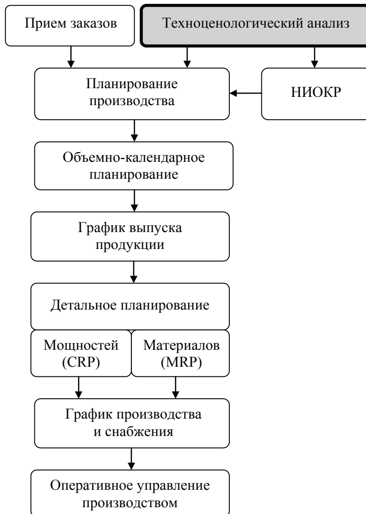
Рис. 1. Модернизированная система управления производством на основе MRP II
