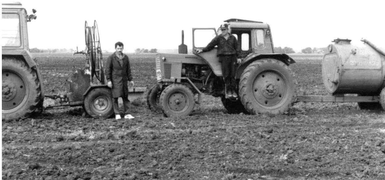
Рис. 1. Транспортное положение комплекса машин по промывке дрен
