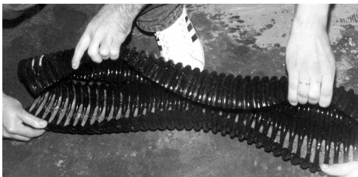
Рис. 4. Определение степени очистки дренажной трубы
