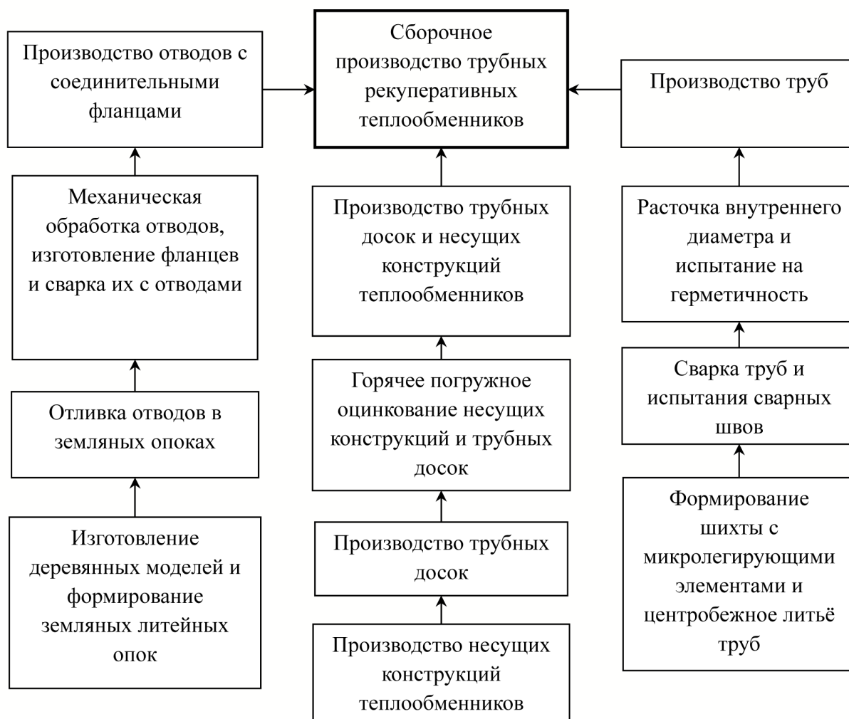
Рис. 4. Система управленческого учета производства рекуперативных трубных теплообменников
