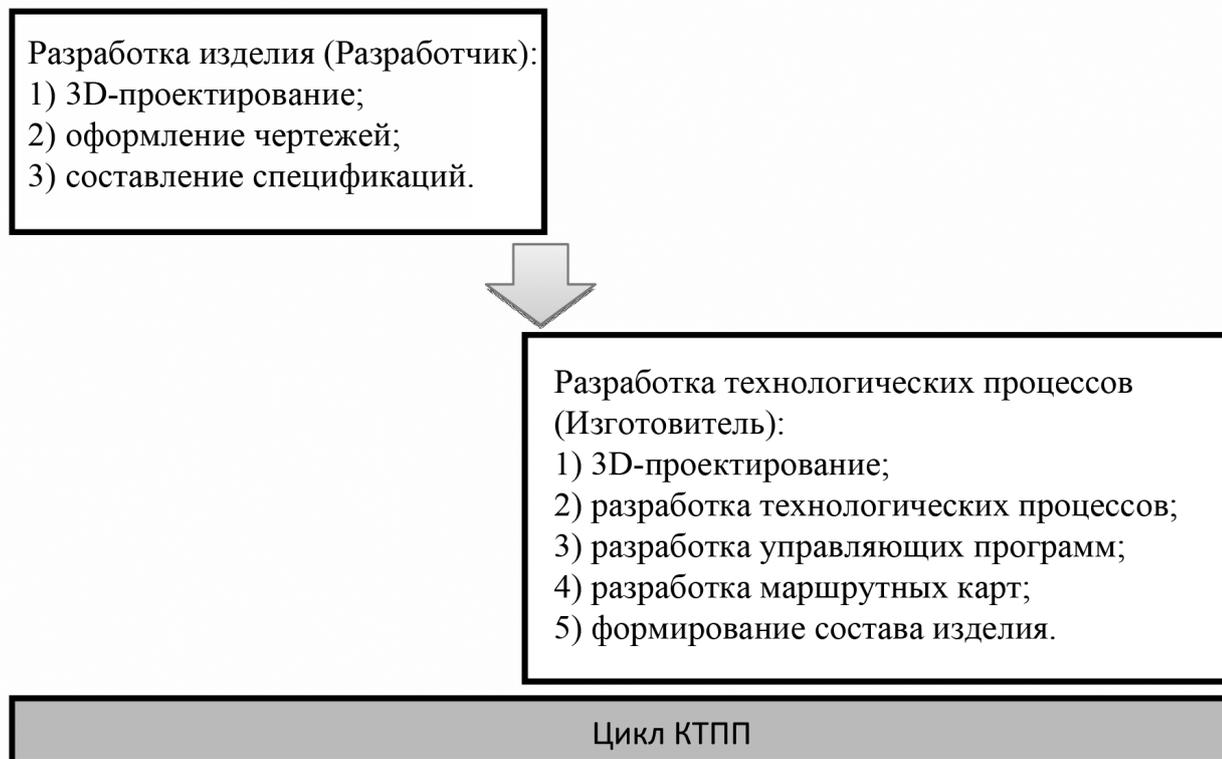
Рис. 4. Цикл КТПП модель традиционного процесса
