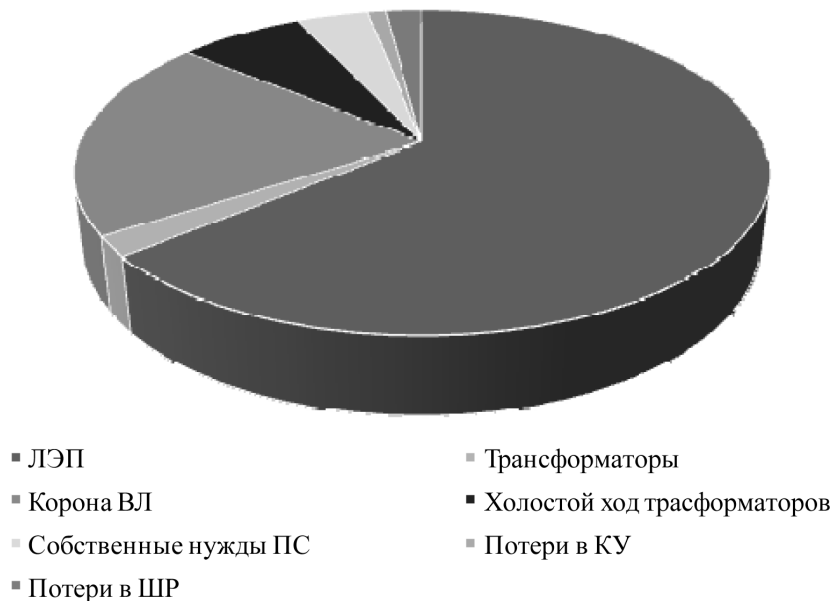
Рис. 3. Среднестатистические составляющие структуры технических потерь электроэнергии в электрических сетях страны [16]
